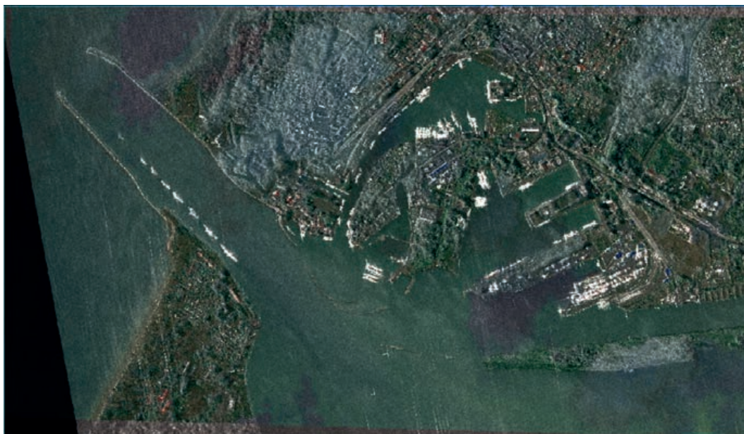
Rys. 3.10. Zintegrowany obraz SAR i EO metodą Grama Schmidta [źródło: opracowanie własne].
