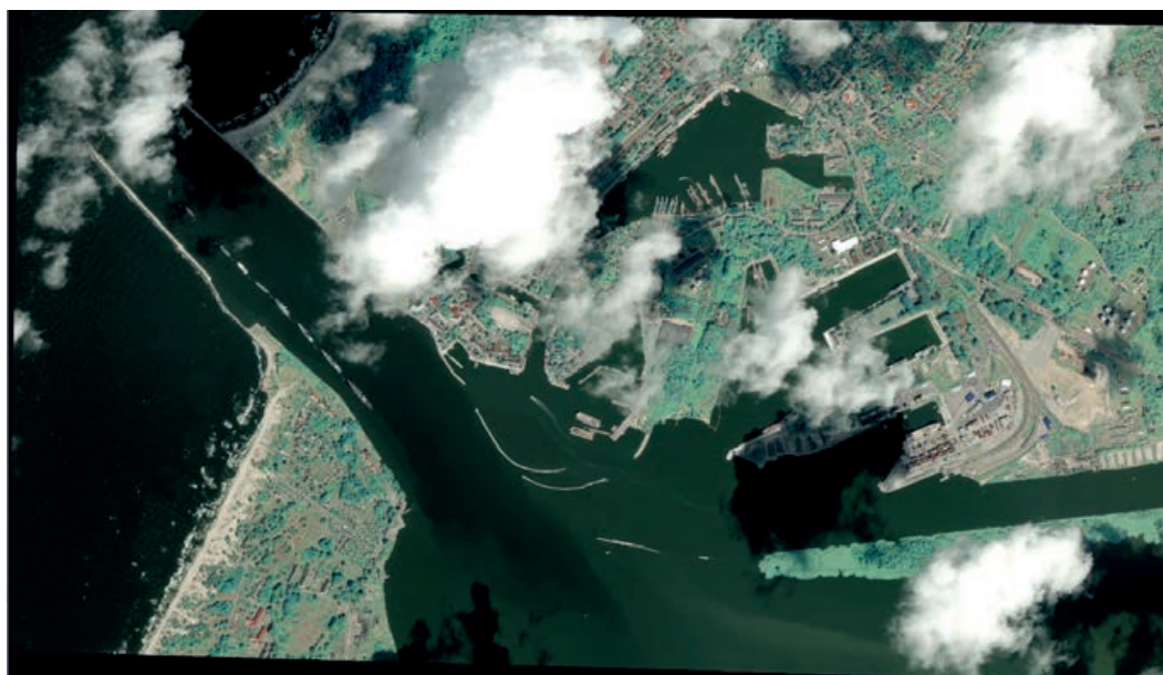
Rys. 3.1. Zobrazowanie EO po operacji pansharpeningu metodą IHS [źródło: opracowanie własne].
