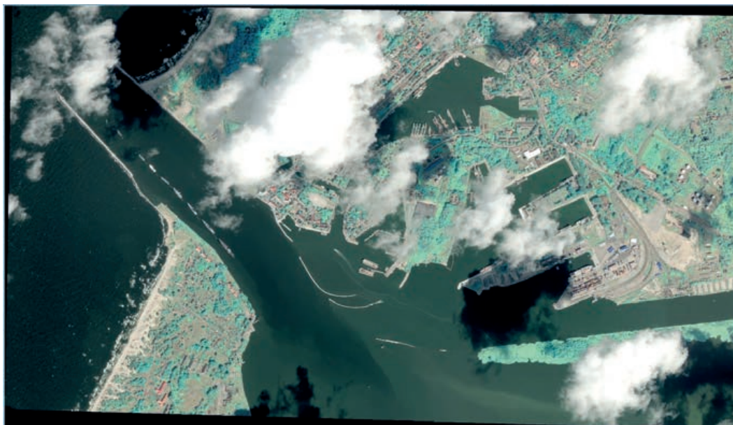
Rys. 3.2. Zobrazowanie EO po operacji pansharpeningu metodą Brovey'a [źródło: opracowanie własne].
