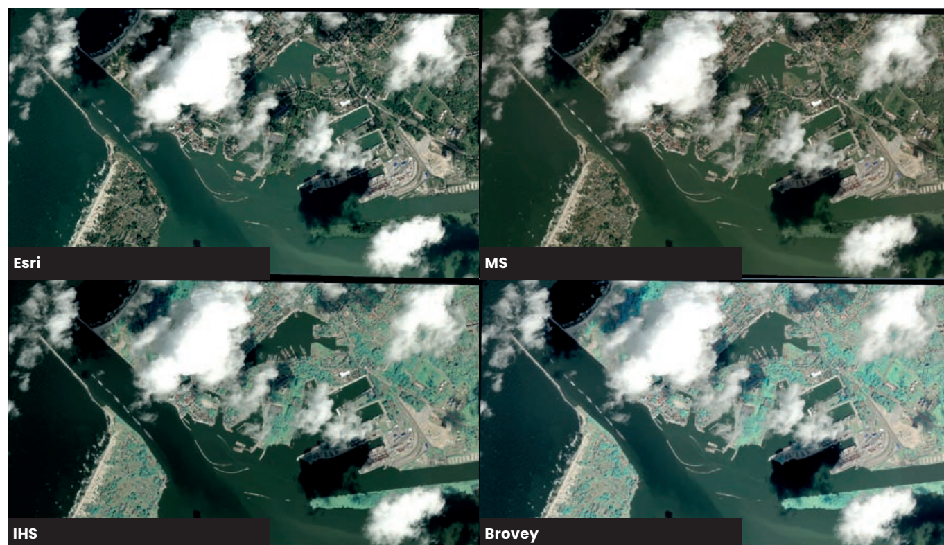
Rys. 4.9. Wyniki metod pansharpeningu [źródło: opracowanie własne].
