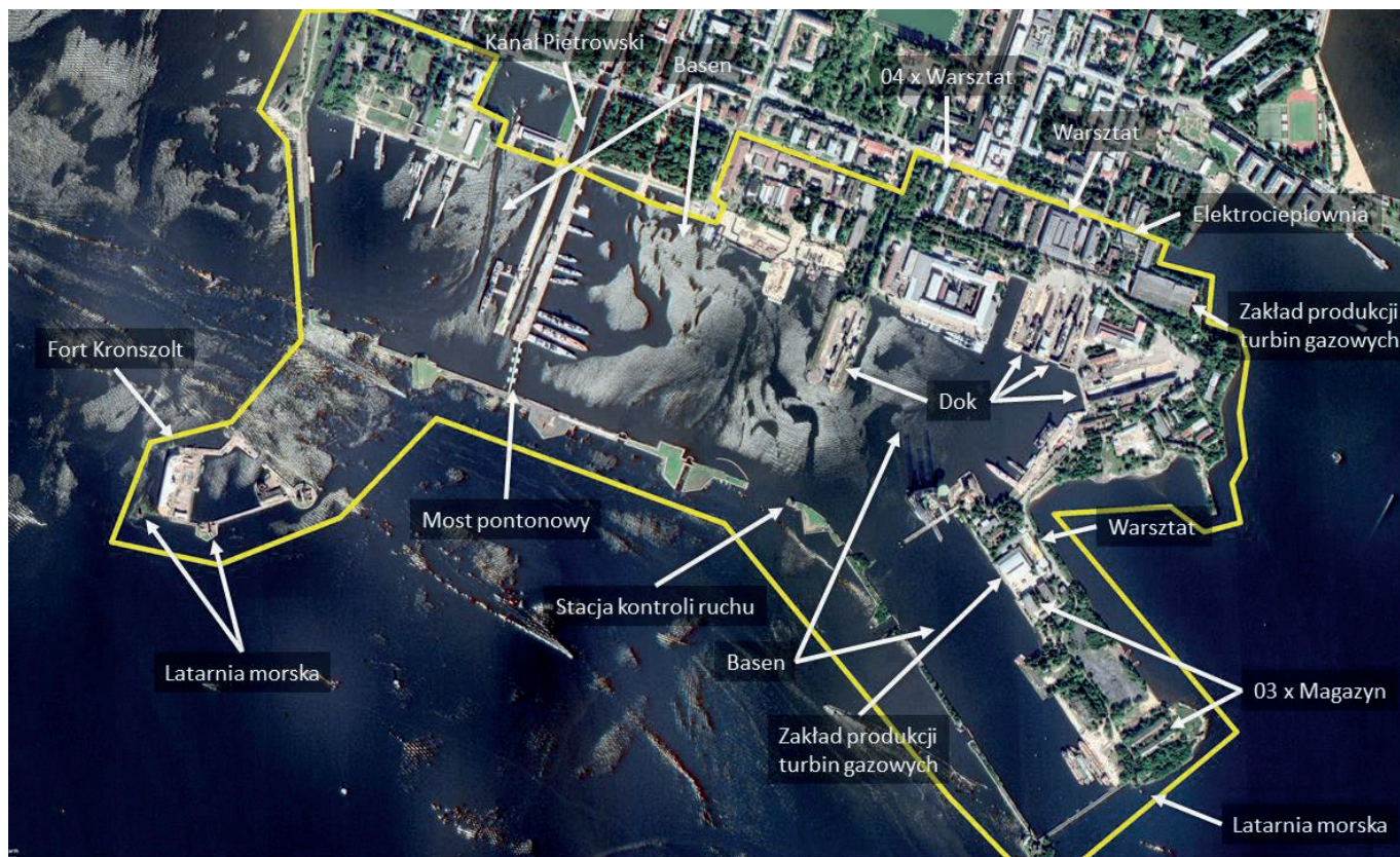
Rys. 2.11. Elementy infrastruktury Bazy Morskiej FB w Kronsztadzie [źródło: opracowanie własne na podstawie: Google Earth Pro, zobrazowanie z dnia 14.08.2022], zobrazowanie z dnia 10.10.2022].
